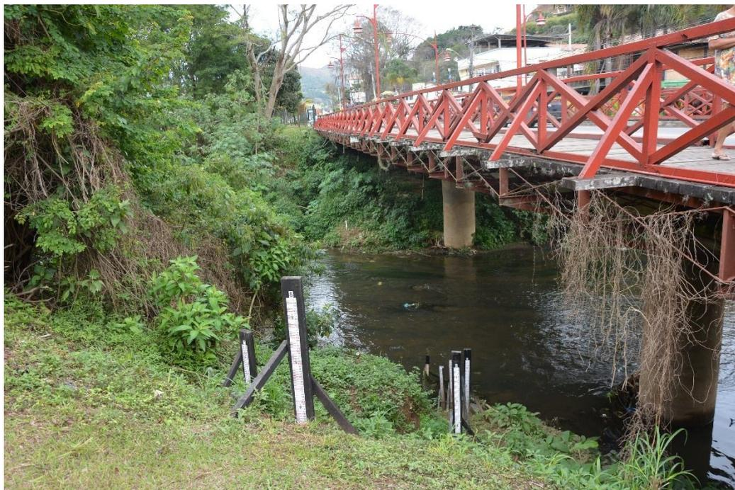
**Figura 12.** Vista das réguas de nível COPPE-UFRJ/CPRM, situada na margem esquerda a montante do ponto 3.
