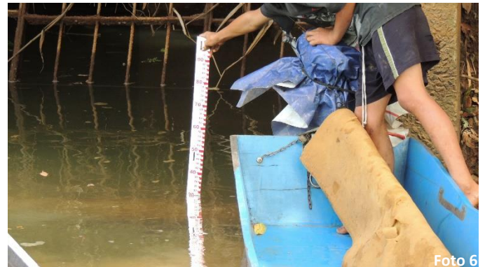
Adução do Rio Paraíba do Sul e verificação da lâmina d'água (30cm)
