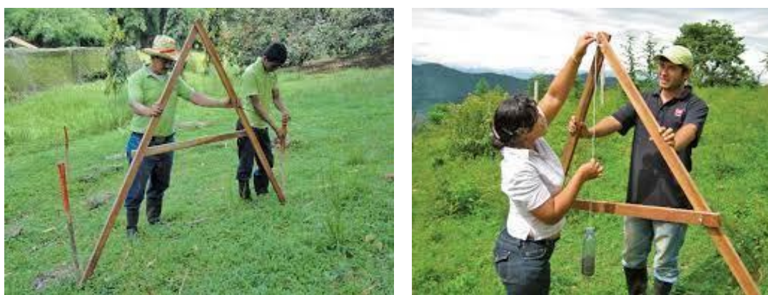
Figura 8 - Exemplos de marcação de curva de nível com utilização de pé-de-galinha (FHIA, 2011).
