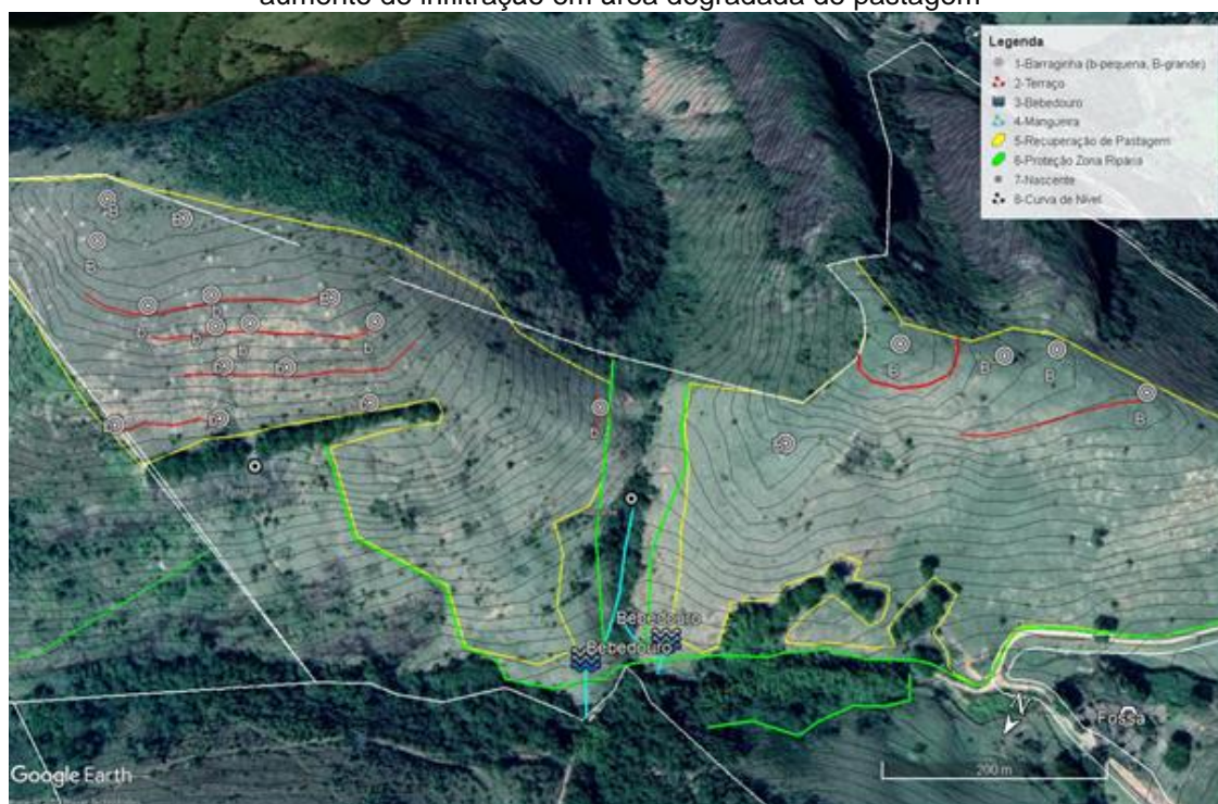
Figura 11 – Visão da propriedade 8 onde serão implantadas barraginhas para controle de erosão, aumento de infiltração em área degradada de pastagem
