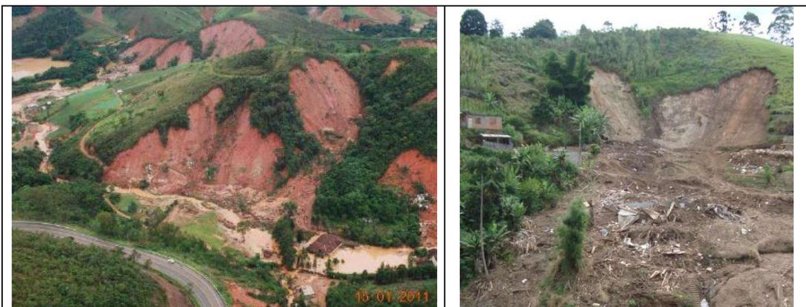
**Figura 3.3.3.4** - Deslizamentos "tipo rasteira" (esquerda) e "tipo vale suspenso" (direita) ocorridos no megadesastre de jan/2011 (DRM-RJ, 2011).
